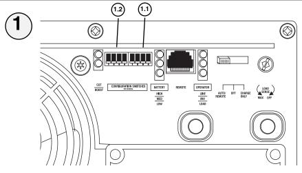
See "Configuration", pg. 5. 1.1 is DIP Switch Group A. 1.2 is DIP Switch Group B. Refiérase a la sección "Configuración", página 20. 1.1 representa el Grupo A de Interruptores DIP. 1.2 representa el Grupo B de Interruptores DIP
